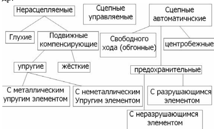
Рис. 17.9. Классификация механических муфт.
