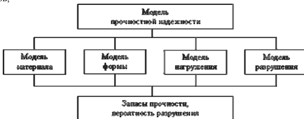
Рис.7.1. Структура модели прочностной надежности элементов конструкций
