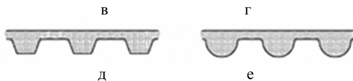
Рис. 15.2. Формы поперечного сечения ремней
